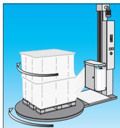
Máquinas semiautomáticas con sistema de plato giratorio
